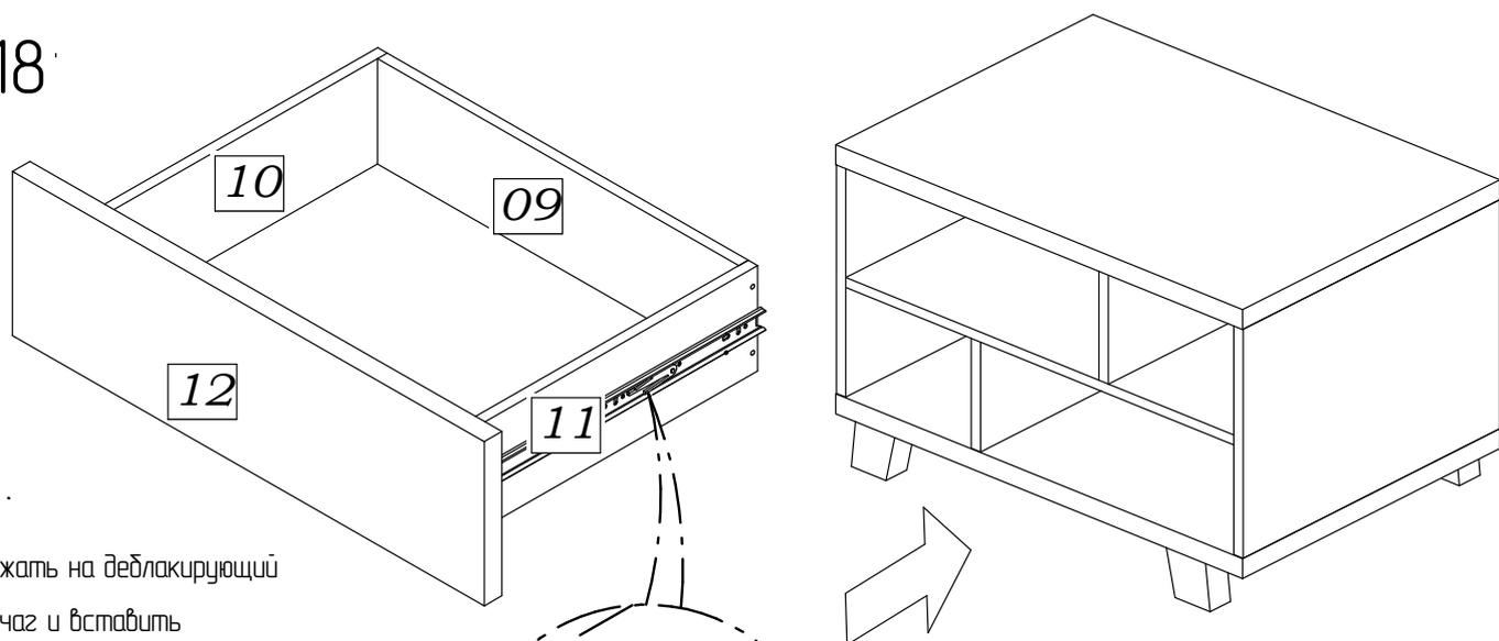
Нажать на деблакирующий рычаг и вставить внутренние направляющие во внешние, задвинув ящик до фиксации деблакирующим рычагом
