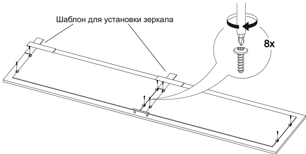
**Внимание!** Монтаж зеркал/стекол к фасадам производится самостоятельно на двусторонний скотч и/или кляймеры **ОБЯЗАТЕЛЬНО** для крепления необходимо использовать монтажный клей «жидкие гвозди»
