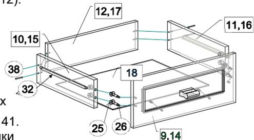
Установите ящики в проем. Закрепите ручки поз. 30 винтами поз. 41. Установите амортизаторы поз. 35 и заглушки поз. 27, 31. На стенки вертикальные поз. 3, 4 закрепите навесы поз. 39 шурупами поз. 38 и закрепите комод к стене, крепеж должен соответствовать материалу стен ( в комплекте
