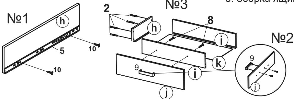
Сборка ящиков комода начинается с №1 - закреплением подвижной планки шариковых направляющих «5» к боковой стенке ящика (h), затем монтируются ручки «9» на фасад (j) №2, после собирается сам ящик №3
